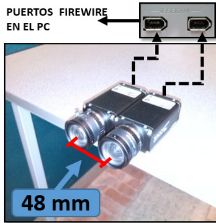
Figure 1. Pair of cameras with FireWire connection for stereo vision / Par de cámaras con conexión firewire para visión estereo
