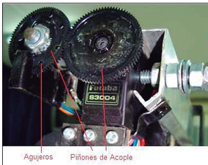
Figura 16. Piñones de acople y agujeros de los sensores de desplazamiento
