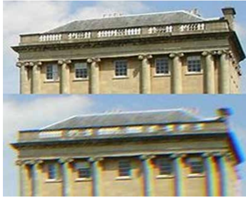
Figura 10. Aberración cromática: la zona de la cornisa se mezcla con el cielo
