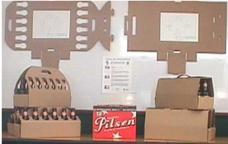
Figura 2. Las dos alternativas finales diseñadas durante el proyecto, al fondo los prototipos de las plantillas troqueladas.
